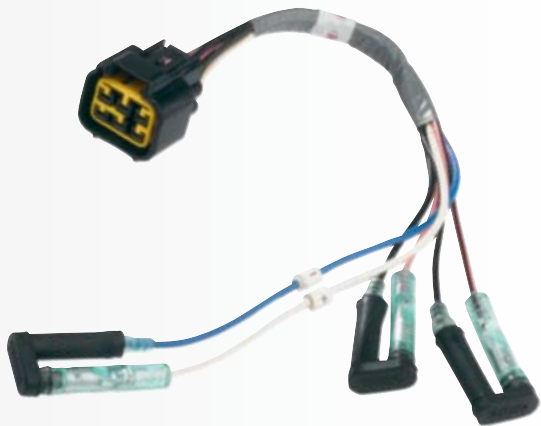
Faisceau de connexion pour 2 jauges à carburant et 1 GPS : 41 € Ce faisceau est utilisé pour connecter un GPS et une ou des jauges à carburant au speedomètre ou au speedo/carburant. Il est équipé d'un connecteur 6 broches (noir) et des connexions nécessaires pour les jauges et le GPS (NMEA 0183) 6Y8-8356N-01-00
