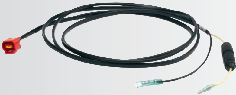
Faisceau d'alimentation avec fusible 10A : 72 € Ce faisceau est utilisé pour alimenter le Bus via la clé de contact. Il est composé du fil de masse (noir) et du fil de + 12V après contact (jaune), sur lequel se trouve un fusible de 16A. Il se termine par un connecteur 2 broches (rouge). 6Y8-83553-01-00
