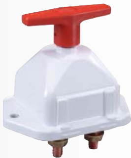
Coupe-batterie bipolaire : 106 € (finition marine, poignée rouge, rondelles et écrous laiton) AMP. (en continu) : 250A AMP. (pendant 5 s.) : 2500A YMF 110 SE1 005
