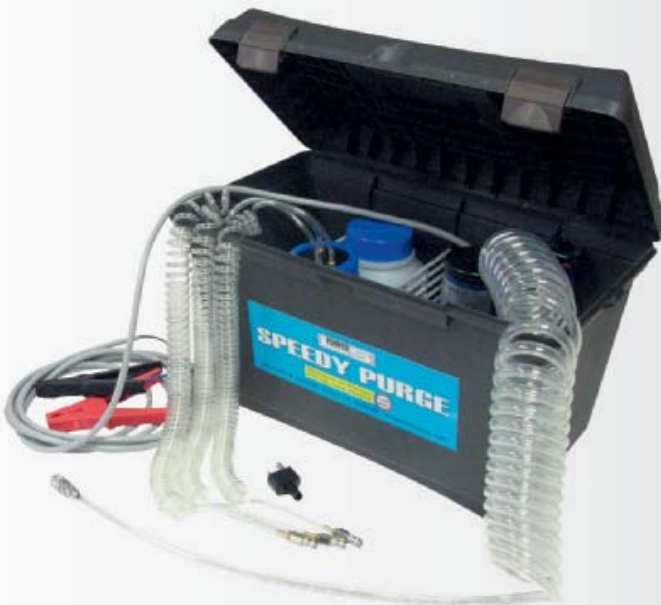
Système de remplissage et purge SPEEDY PURGE : 1159 € Le SPEEDY PURGE LS est un outillage conçu pour remplir et purger les directions hydrauliques LS équipant les bateaux de 5 à 15 mètres. Le SPEEDY PURGE LS se connecte directement par des prises crocodiles à la batterie 12V du bateau et se raccorde au vérin et à la pompe grâce à ses tuyaux transparents spiralés de 2 x 4 mètres. Facilement transportable et autonome, sa contenance de 3 litres d'huile permet de mettre en service 2 ou 3 directions à la suite sans refaire le plein. L'opération de remplissage et de purge réalisée proprement par un technicien seul en moins de 10 mn permet l'amortissement du SPEEDY PURGE sur les 12 premières directions. YMF 112 202 842
