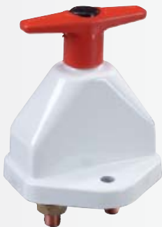
Coupe-batterie unipolaire : 45 € (finition marine, poignée rouge, rondelles et écrous laiton) AMP. (en continu) : 250A AMP. (pendant 5 s.) : 2500A YMF 110 SE1 004
