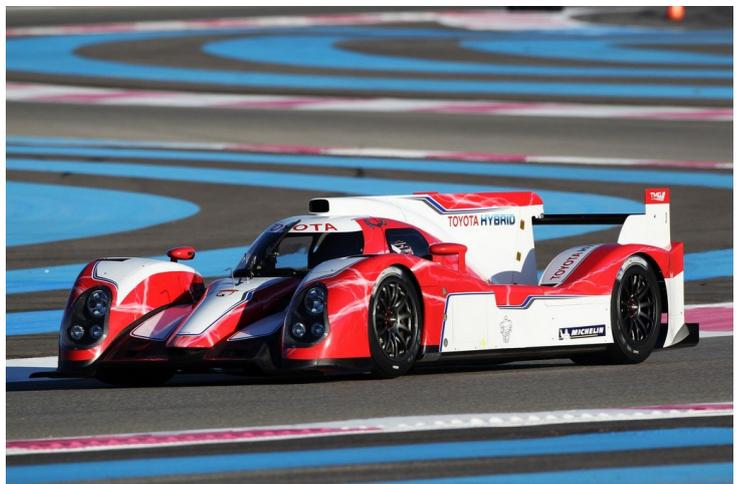
Le groupe motopropulseur TOYOTA HYBRID System – Racing intègre un nouveau système hybride et un moteur essence atmosphérique V8 de 3,4 litres. L'énergie est produite lors du freinage comme pour les voitures routières à système hybride intégral de TOYOTA. La voiture de course TS030 HYBRID roule aussi en mode « électrique », avec zéro émissions et zéro consommation de carburant.
