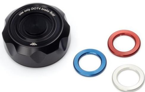
Bouchon de maître-cylindre arrière taillée dans la masse
