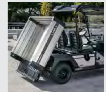
Benne et ridelle arrière basculantes (capacité de 363 kg).
