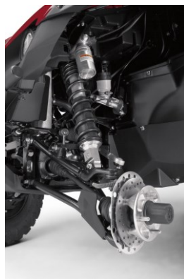
Suspensions à bonbonne séparée entièrement réglables
