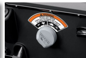
« speed key » contrôle de vitesse double positions
