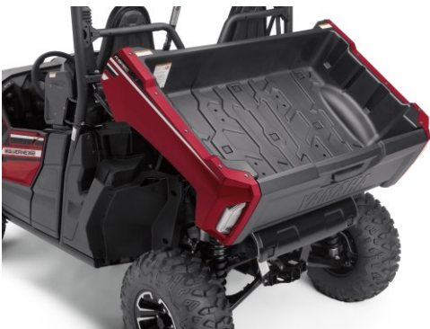
Benne basculante 272 kg de charge
