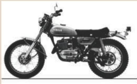
de suspensions plus longues. Son moteur doté du graissage séparé et du système "Torque Induction" développe 24 chevaux, soit un gain de trois chevaux. L'alimentation est confiée à un carburateur de 26 mm de diamètre et la boîte de vitesses est à cinq rapports.
