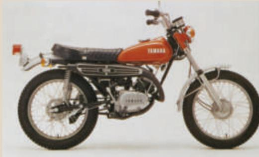
Les modifications les plus significatives de la DT-2 se trouvent faites sur la partie-cycle avec l'adoption d'une roue avant de 21 pouces et
