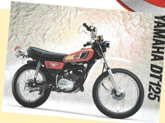
La DT 125 se distingue immédiatement de la version MX par sa suspension arrière assurée par deux amortisseurs en place du célèbre "Cantilever".
