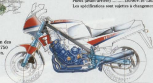
Le carénage semi-intégral étudié en soufflerie procure à la fois une bonne pénétration dans l'air et une protection efficace qui contribue largement au confort de conduite. Il est monté directement sur le cadre pour éviter que le poids n'affecte la direction.
