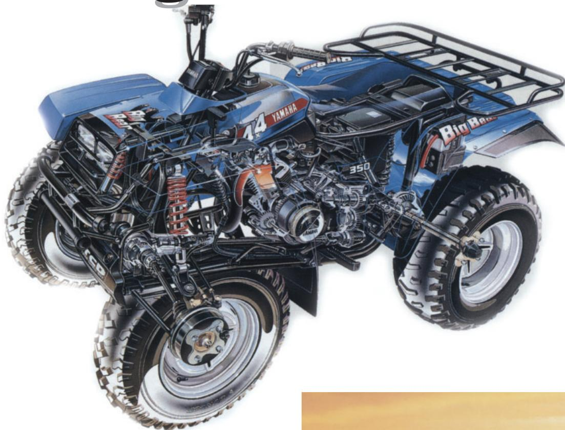
Parmi sa gamme de quads, à l'époque dits "agricoles", Yamaha propose le Big Bear 350. Quatre roues motrices, moteur monocylindre de 348 cm<sup>3</sup> développant 22,6 chevaux, cinq vitesses et marche arrière ... Bref, du sérieux et du costaud pour la campagne.
