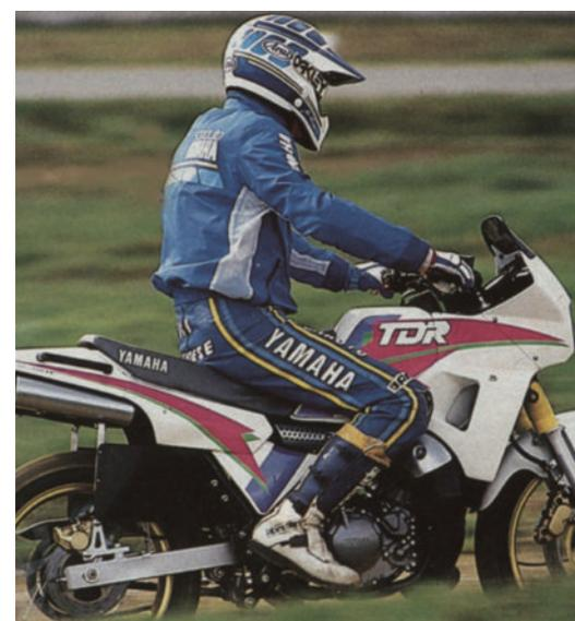
Un bicylindre à "eau" de 44 chevaux dans une partie-cycle efficace et un poids plume de 159 kg font un cocktail détonnant baptisé TDR 250.
