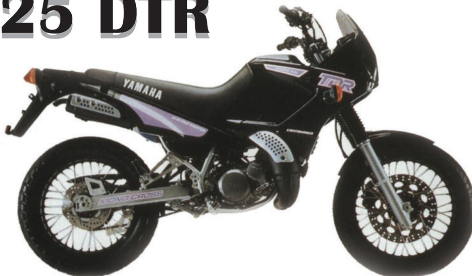
La DTR 125 est propulsée par un monocylindre 2 temps avec refroidissement liquide. Dotée de l'YPVS et de YEIS, la nouvelle 125 Yamaha est aussi bien pourvue côté partie-cycle avec par exemple une suspension monocross dérivée de
