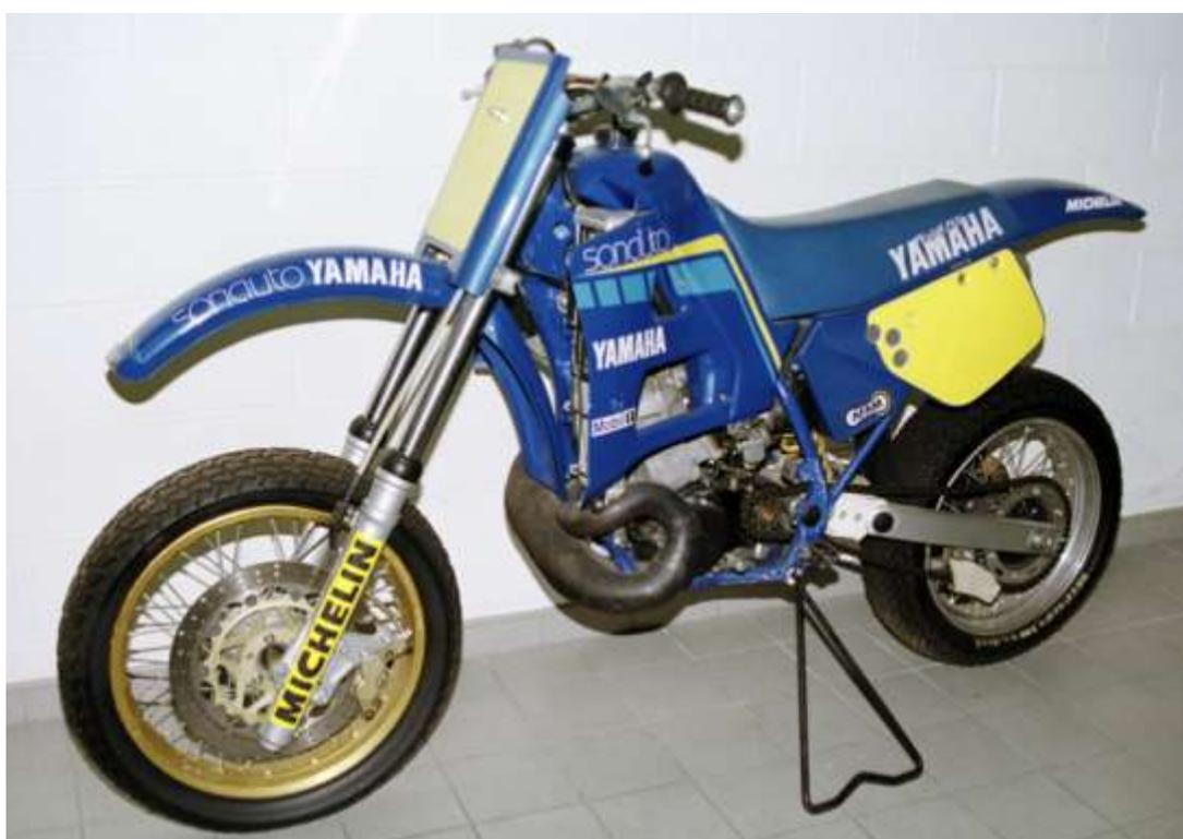
Cette moto est le premier prototype de machine type supermotard réalisée avec un kit moteur JPX (cylindre, piston, segment et culasse) à refroidissement liquide JPX d'une cylindrée de 535 cm<sup>3</sup>. L'adoption de ce nouveau haut moteur permet au bloc propulseur de délivrer une puissance d'environ 56 chevaux. Pilotée par Stéphane Peterhansel, cette moto s'illustre, grâce au talent de son pilote, dans différentes épreuves spécifiquement organisées pour ce type de machines.
