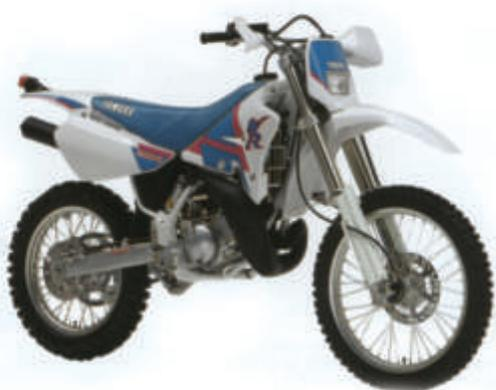
Yamaha présente au Mondial de Paris sa nouvelle WR 200, une moto d'enduro propulsée par un mono 2 temps à refroidissement liquide avec admission par clapet dans le carter, dotée de l'YPVS et d'une boîte six vitesses.
