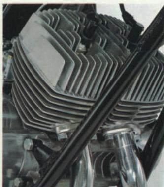
Le moteur à 2 cylindres en parallèle à 2 temps et 5 orifices vous garantit plus de puissance. Le système de super balayage augmente de 10% la puissance et les performances de la machine.
