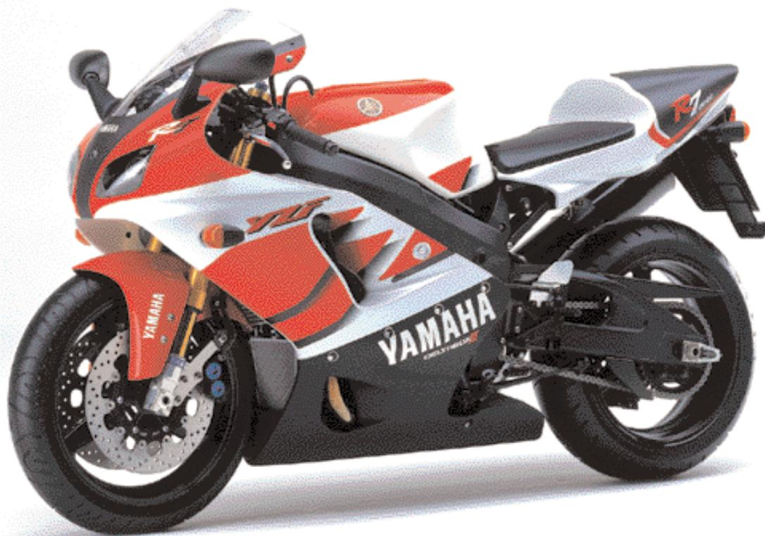
La R7 est à l'avant-garde de la technologie avec son moteur dérivé du concept Génésis qui possède, entre autres, cinq soupapes en titane par cylindre, des bielles elles aussi en titane, une injection électronique à deux injecteurs par cylindre, et un carter moteur/bloc cylindres monobloc avec traitement céramique des cylindres. La partie-cycle de la R7 est digne de sa motorisation avec des compo-
