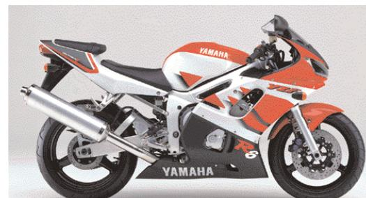
que avec étriers double piston et à l'arrière à un simple disque. Le quatre cylindres de 599 cm<sup>3</sup> développe une puissance de 106 ch à 13 000 tr/mn et un couple de 6,47 kg-m. Equipé d'un bloc cylindre et carter monobloc, de bielles carburisées, de pistons forgés à faible friction, de carburateurs CVRD de  $\varnothing$  37 mm, ce moteur est capable d'accrocher un régime maxi de 15 500 tr/mn.
